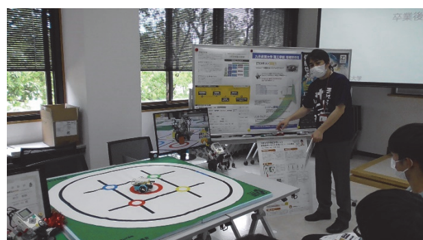
図 4 AI を活用した自律型走行ロボット
