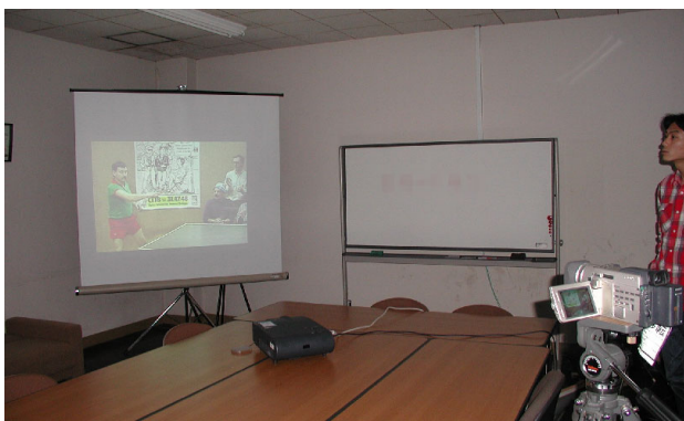
図 12 評価実験の様子：透かし入りビデオをスクリーンに投射してデジタルビデオカメラで撮影し、録画されたビデオから透かし情報の検出を行っています。
