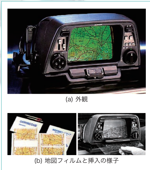
図-1 世界初のカーナビゲーションシステム
